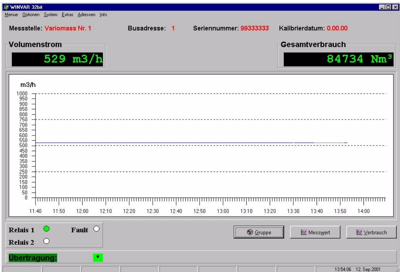
Der dargestellte Messbereich (Y-Achse) und die Einheit (hier: 0 - 1000 Nm<sup>3</sup>/h) wird aus der angeschlossenen Gerät ausgelesen und kann ggf. im Menü Grundeinstellungen geändert werden.
