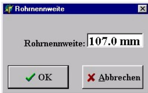
Die voreingestellte Rohrenweite muß auf den tatsächlichen Rohrinndurchmesser der Messstelle abgeglichen werden. Der Rohrinndurchmesser kann den Wert zwischen 020.0 und 510.0 mm annehmen. Der eingegebene Wert muss mit dem "OK" bestätigt werden um eine Übertragung an die Elektronik zu bewirken.
