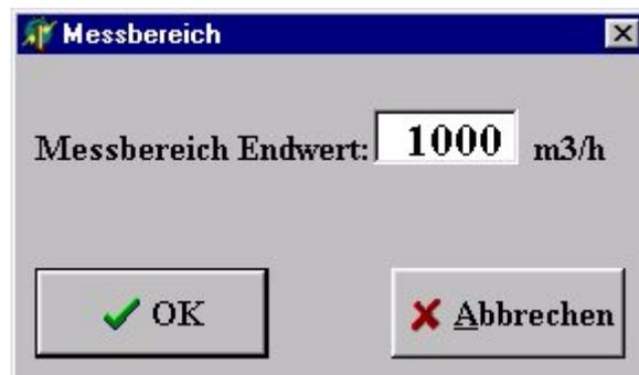
Der Messbereich Endwert kann jetzt eingegeben werden, wobei der Wert (hier: 1000 m<sup>3</sup>/h) zwischen 10 und 60000 m<sup>3</sup>/h mittels numerischer Eingabetasten eingetragen werden kann. Benutzen Sie die Tabulator Taste oder den Mauszeiger um das Eingabefeld zu aktivieren (blaue Färbung). Der Anfangswert des Meßbereiches steht immer auf den Wert Null. Nach Eingabe des 5-stelligen Wertes (01234) ist das Eingabefeld mit dem "OK Button" zu schliessen.
