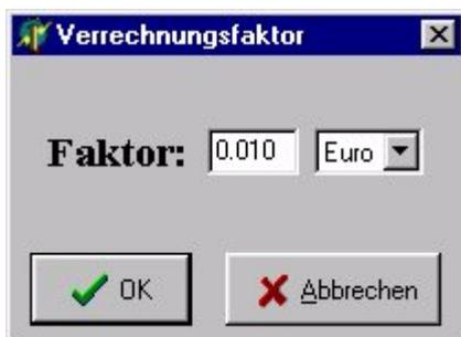
Der Verbrauchsfaktor bestimmt den Preis pro Kubikmeter verbrauchter Druckluft, der zur Berechnung herangezogen wird. In dem Fenster kann ein Preis pro Kubikmeter von 0,001 bis 9,999 herangezogen werden mit entsprechender Währung, die per Pull Down Menü ausgewählt werden kann. Die Eingabe des Umrechnungsfaktor ist mit dem "OK" Button zu bestätigen und zu schließen. Der Umrechnungsfaktor wird in dem Feld „Verbrauch berechnen“ und „Gruppen Verbrauch“ herangezogen.
