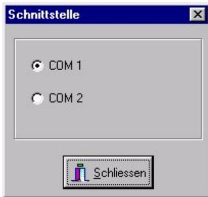
Die serielle Schnittstelle kann mit dem Mauszeiger ausgewählt werden durch Anklicken der Kreise neben der COM 1 oder COM 2 Adresse entsprechend Ihrer Hardware. Nach Änderung schließen Sie das Fenster durch drücken des Buttons "Schliessen" wodurch Ihre Änderungen gespeichert werden. Die Baudrate darf nicht geändert werden und muss auf 9600 baud stehen.
