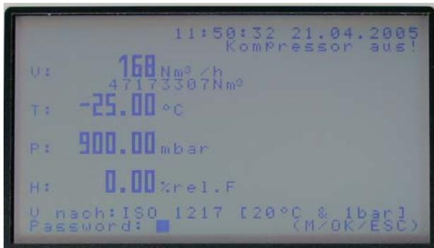
Die oberste Zeile zeigt die aktuelle Uhrzeit und das Datum an und in der zweiten Zeile den Status des optionalen fünften digitalen Eingangs (Wert 1 oder 0 für Kompressor an oder Kompressor aus). In der rechten freien Fläche wird der Zustand der Relais Kontakte optional angezeigt, falls diese aktiviert wurden. In der unteren Zeile wird der aktuelle Normzustand angezeigt (z.B. nach ISO 1217) und nach Drücken der Taste „Buch“ kann das Passwort eingegeben werden, falls Änderungen durchzuführen sind.
