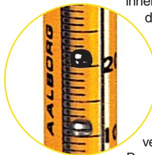
Skalen dieser Art gestatten die Verwendung eines einzigen Strömungsmessers für eine große Anzahl verschiedener Fluide bei unterschiedlichen Druck- und Temperaturbedingungen.
