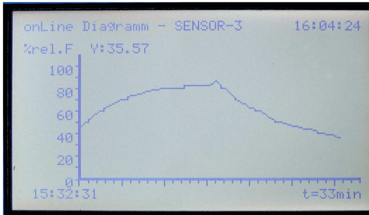
Das große grafikfähige Display (Abmessungen B x H: 120 x 65 mm) kann auch zur kurzzeitigen Online Aufzeichnung für jeden Kanal genutzt werden. Diese Darstellung ist unabhängig vom Datenlogger und dient der Kontrolle. Die Skalierung erfolgt über den Eingang der Messgröße. Das Zeitfenster ist auf 30 Minuten fest eingestellt. Per Tastatur kann jeder einzelne Kanal sehr schnell angewählt wählen. Die Menüführung ist sehr übersichtlich gegliedert. Neu in der Bedienung
