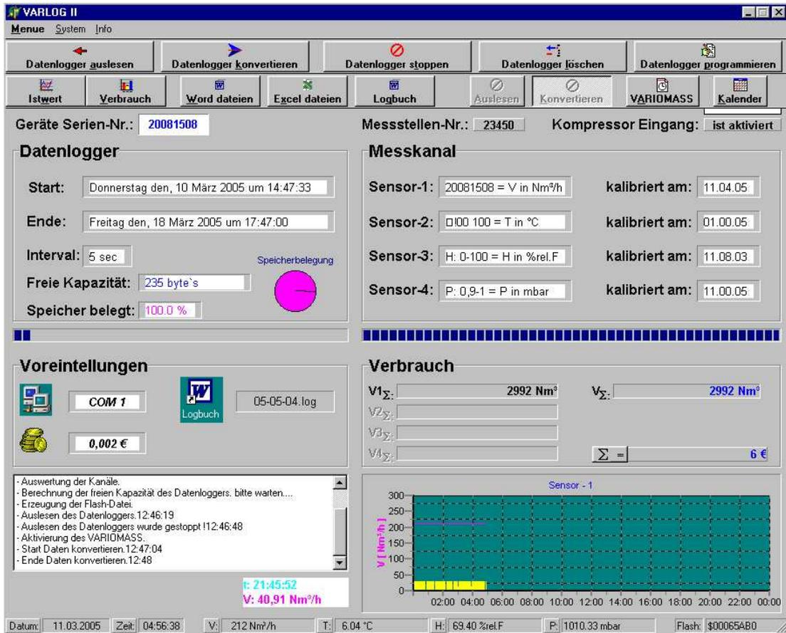
Bei dem Einsatz maximaler Anzahl an Sensoren, können bis zu 5 Grafiken (z.B. Volumenstrom, digitaler Eingang, Temperatur, rel. Feuchte und Druck) auf einer Maske dargestellt werden. Alle Grafiken könne direkt ausgedruckt oder die Daten können nach EXCEL exportiert werden.
