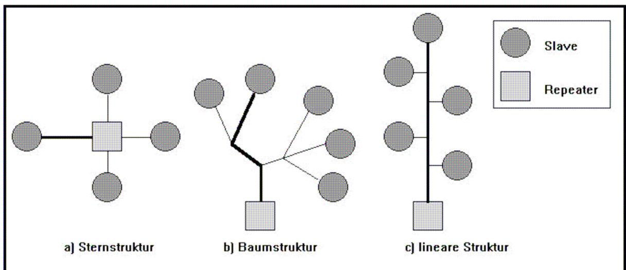
Empfohlen wird die lineare Struktur. Diese Topologie ist sehr kostengünstig, es wird nicht gestört, wenn eine der Komponenten ausfällt, und es ermöglicht die Übertragung von Daten zu allen Komponenten (Broadcasting) oder auf bestimmte Gruppen in das System (Multicasting).
